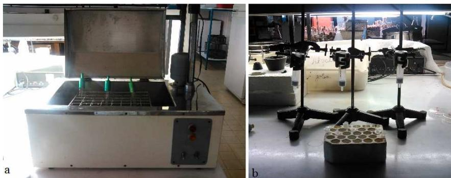
Figura 7. a) Hidrólise ácida, em banho-maria, a 100°C. b) Filtração do hidrolisado em coluna Chromabond C18.
