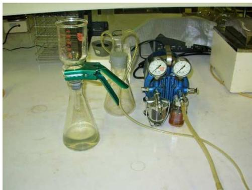
Figura 4. Sistema de filtração Buchner e bomba de vácuo Millipore utilizados para filtração e lavagem da biomassa.
