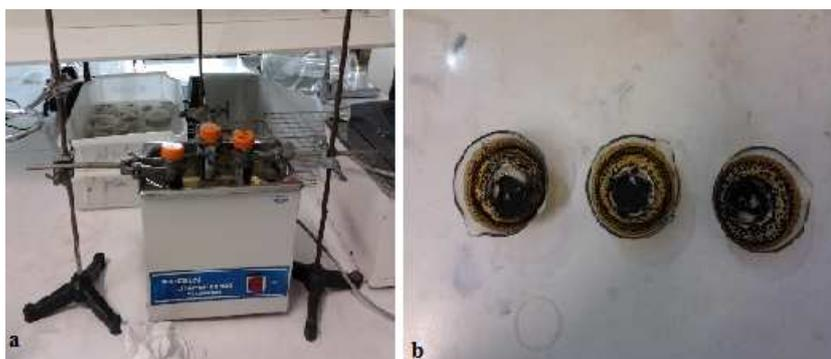
Figura 5. a) Biomassa seca com os solventes metanol e acetona (1:1) em ultrassons. b) Cadinhos com a biomassa seca depois de sujeita a banho de ultrassons e secagem.
