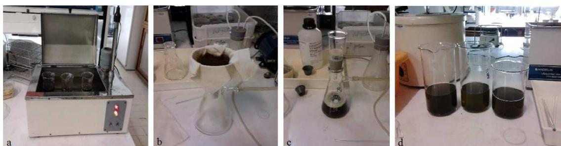
Figura 6. a) Gobelé com a biomassa seca e NaOH, em banho-maria a 90°C. b) Filtração grosseira usando vácuo e pano-cru. c) Filtração fina usando vácuo com funil de malha G0. d) Precipitação em etanol a 100%.
