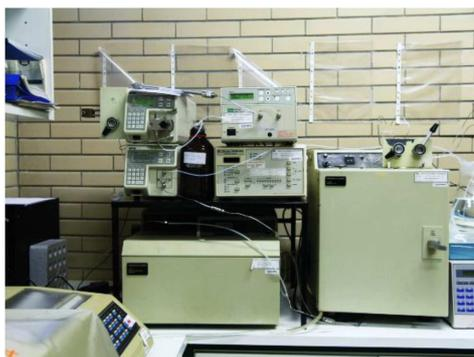
Figura 8. Aparelho de HPLC (cromatografia líquida de alta pressão).
