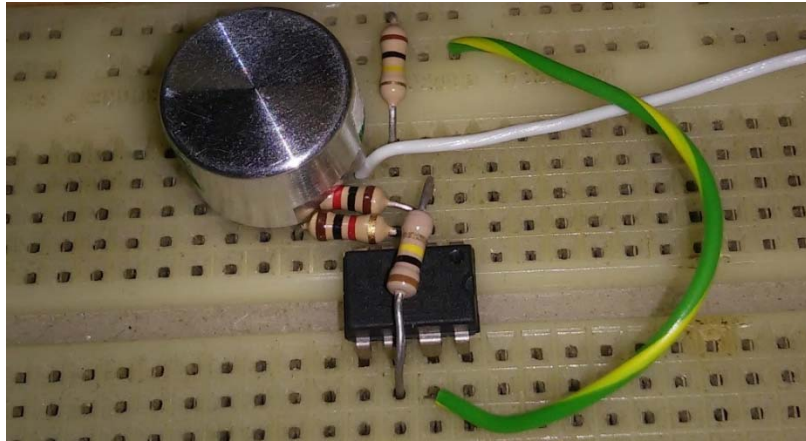
Figura 5.10: Circuito Montado com Partes Condutoras Reduzidas
