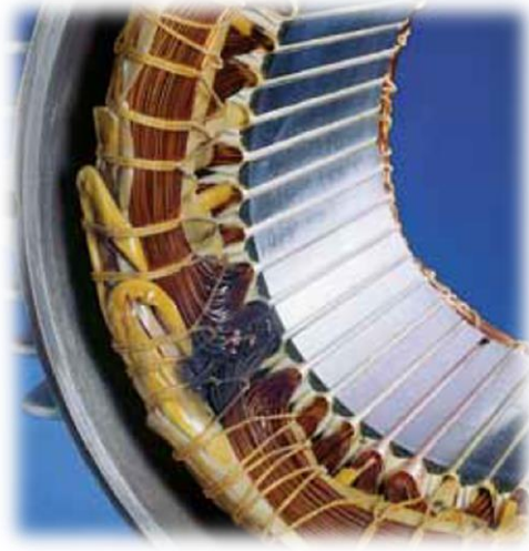
Fig. 2.10. Dano nos enrolamentos do estator atribuído aos picos de tensão da alimentação do motor [174].
