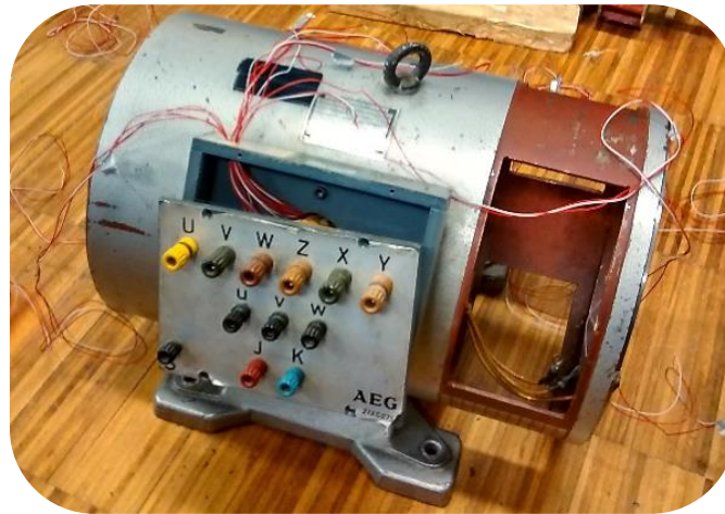
Fig. 5.7. Motor AEG durante a fase de instalação do sensores térmicos PT100.
