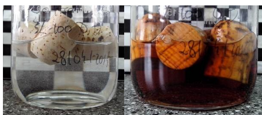
Figura 2.338. Rolhas com revestimento de SoftCAT SL-100 0,1 % em etanol 40 % (v/v), 0 horas e 10 dias a 60 °C, respetivamente
