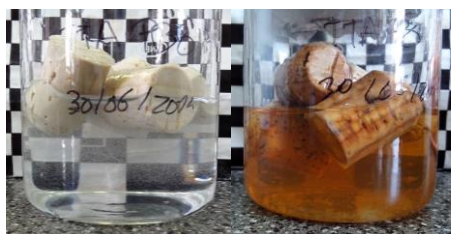
Figura 2.46. Rolhas com revestimento de TTA PBO em etanol 40 % (v/v), 0 horas e 10 dias a 60 °C, respetivamente
