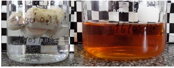
Figura 2.326. Rolhas com revestimento de SoftCAT SL-30 0,1 % em etanol 40 % (v/v), 0 horas e 10 dias a 60 °C, respetivamente
