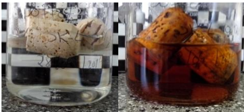
Figura 2.267. Rolhas com revestimento de SoftCAT SK-L 0,1 % em etanol 40 % (v/v), 0 horas e 10 dias a 60 °C, respectivamente
