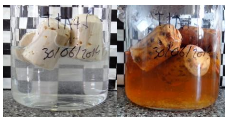
Figura 2.40. Rolhas com revestimento de TTA++ em etanol 40 % (v/v), 0 horas e 10 dias a 60 °C, respetivamente
