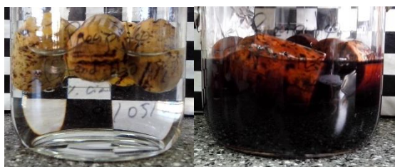
Figura 2.164. Rolhas com revestimento de Avicel 5 % em etanol 50 % (v/v), 0 horas e 10 dias a 60°C, respectivamente
