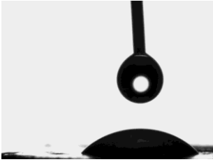
Figura 2.28. Gota de água sobre a superfície de cortiça revestida com TTA PO a pH 5. AC=51,56 ± 3,39
