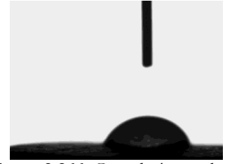
Figura 2.266. Gota de água sobre a superfície de cortiça revestida com SoftCAT SK-H 1%. AC = 76,58 \pm 9,46 (n=6)
