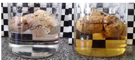
Figura 2.201. Rolhas com revestimento de CMC 0,1 % em etanol 40 % (v/v), 0 horas e 1 semana, respectivamente
