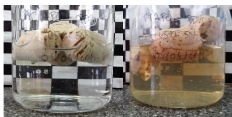
Figura 2.108. Rolhas com revestimento de TTA PO-PDMS em etanol 40 % (v/v), 0 horas e 1 semana, respectivamente
