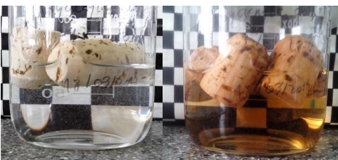
Figura 2.146. Rolhas com revestimento de PAA, Mv 4.000.000 1 % em etanol 40 % (v/v), 0 horas e 1 semana, respetivamente
