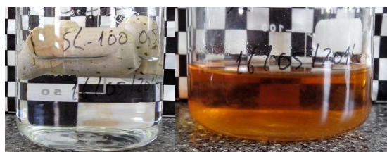
Figura 2.340. Rolhas com revestimento de SoftCAT SL-100 0,5 % em etanol 40 % (v/v), 0 horas e 10 dias a 60 °C, respetivamente
