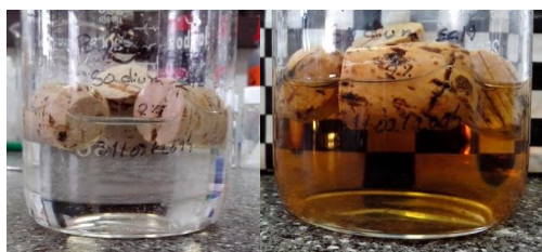
Figura 2.156. Rolhas com revestimento de PAA, sal sódio 2 % em etanol 40 % (v/v), 0 horas e 1 semana, respetivamente
