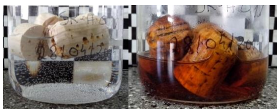
Figura 2.285. Rolhas com revestimento de SoftCAT SK-H 0,1 % em etanol 40 % (v/v), 0 horas e 10 dias a 60 °C, respetivamente
