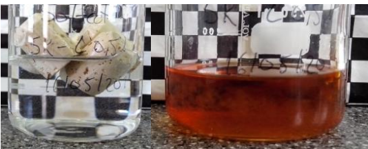
Figura 2.269. Rolhas com revestimento de SoftCAT SK-L 0,5 % em etanol 40 % (v/v), 0 horas e 10 dias a 60 °C, respectivamente
