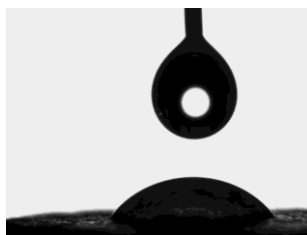
Figura 2.98. Gota de água sobre a superfície de cortiça revestida com TTA PO-PDMS. AC=61,66 \pm 7,62
