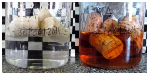
Figura 2.36. Rolhas com revestimento de TTA em etanol 40 % (v/v), 0 horas e 10 dias a 60 °C, respectivamente
