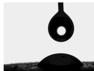
Figura 2.99. Gota de água sobre a superfície de cortiça revestida com TTA PBO-PDMS. AC=59,92 \pm 12,25
