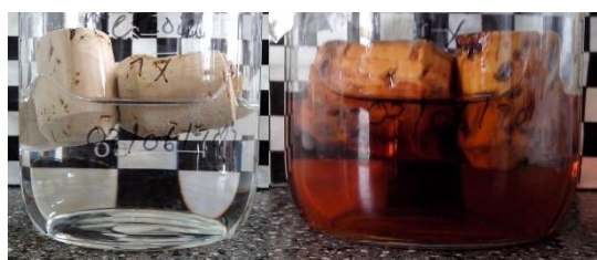
Figura 2.190. Rolhas com revestimento de HPMC Mw 120.00 1 % em etanol 50 % (v/v), 0 horas e 10 dias a 60°C, respetivamente
