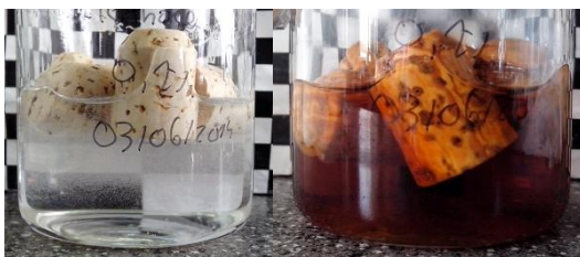
Figura 2.186. Rolhas com revestimento de HPMC Mw 120.000 0,1 % em etanol 50 % (v/v), 0 horas e 10 dias a 60°C, respetivamente
