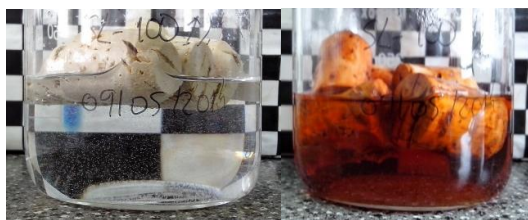
Figura 2.342. Rolhas com revestimento de SoftCAT SL-100 1 % em etanol 40 % (v/v), 0 horas e 10 dias a 60 °C, respetivamente
