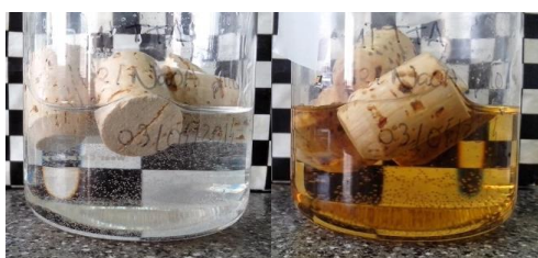
Figura 2.74. Rolhas com revestimento de TTA e NaOH em etanol 40 % (v/v), 0 horas e 1 semana, respectivamente
