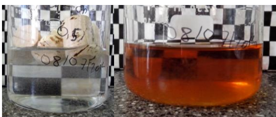
Figura 2.382. Rolhas com revestimento de xantana 0,5 % em etanol 50 % (v/v), 0 horas e 10 dias a 60°C, respectivamente
