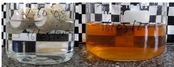
Figura 2.334. Rolhas com revestimento de SoftCAT SL-60 0,5 % em etanol 40 % (v/v), 0 horas e 10 dias a 60 °C, respetivamente
