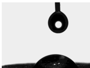
Figura 2.23. Gota de água sobre a superfície de cortiça revestida com TTA++ pH 2,23. AC= 63,84 \pm 3,74
