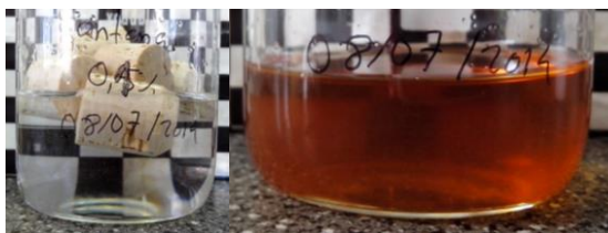
Figura 2.380. Rolhas com revestimento de xantana 0,1 % em etanol 50 % (v/v), 0 horas e 10 dias a 60°C, respectivamente
