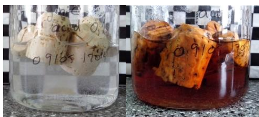
Figura 2.367. Rolhas com revestimento de alginato de sódio 0,1 % em etanol 50 % (v/v), 0 horas e 10 dias a 60°C, respetivamente
