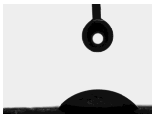
Figura 2.22. Gota de água sobre a superfície de cortiça revestida com TTA+ pH 5. AC= 56,07 \pm 2,67
