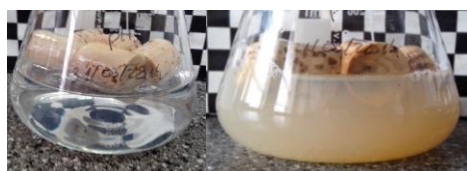
Figura 2.54. Rolhas com revestimento de TTA PO pH5 em etanol 40 % (v/v), 0 horas e 1 semana, respetivamente
