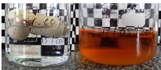
Figura 2.336. Rolhas com revestimento de SoftCAT SL-60 1 % em etanol 40 % (v/v), 0 horas e 10 dias a 60 °C, respetivamente
