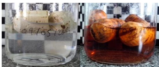
Figura 2.355. Rolhas com revestimento de CMC 0,1% e JR125 0,1% em etanol 50 % (v/v), 0 horas e 10 dias a 60°C, respetivamente
