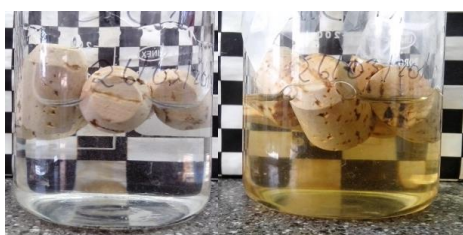
Figura 2.205. Rolhas com revestimento de CMC 1 % em etanol 40 % (v/v), 0 horas e 1 semana, respectivamente
