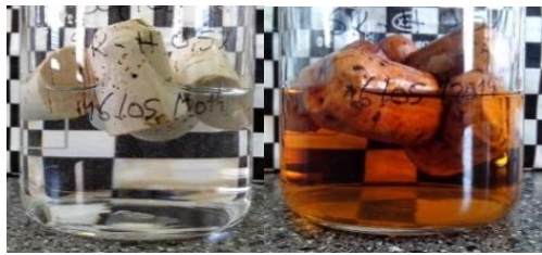
Figura 2.287. Rolhas com revestimento de SoftCAT SK-H 0,5 % em etanol 40 % (v/v), 0 horas e 10 dias a 60 °C, respetivamente
