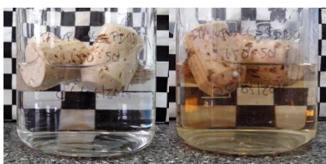
Figura 2.106. Rolhas com revestimento de TTA WP WCL-PDMS em etanol 40 % (v/v), 0 horas e 1 semana, respectivamente
