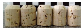
Figura 2.66. Rolhas revestidas com TTA PBO após passagem por uma solução de NaOH
