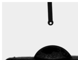
Figura 2.131. Gota de água sobre a superfície de cortiça revestida com PAA Mw 4.000.000 0,1 % pH6,5. AC=71,97 ± 9,92
