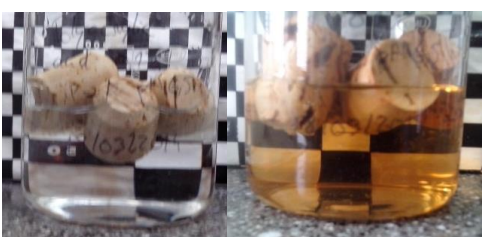
Figura 2.150. Rolhas com revestimento de PAA, Mv 4.000.000 0,1% pH6,5 em etanol 40% (v/v), 0 horas e 1 semana, respetivamente
