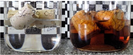
Figura 2.328. Rolhas com revestimento de SoftCAT SL-30 0,5 % em etanol 40 % (v/v), 0 horas e 10 dias a 60 °C, respetivamente
