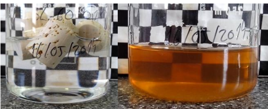
Figura 2.332. Rolhas com revestimento de SoftCAT SL-60 0,1 % em etanol 40 % (v/v), 0 horas e 10 dias a 60 °C, respetivamente
