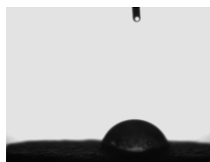
Figura 2.354. Gota de água sobre a superfície de cortiça revestida com CMC 0,5 % e JR125 0,5 % após passar por água desionizada. AC= 96,52 \pm 22,17 (n=7)
