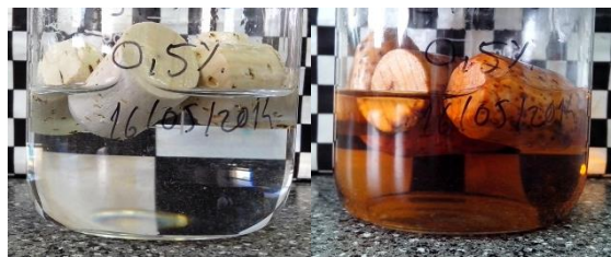
Figura 2.226. Rolhas com revestimento de JR125 0,5 % em etanol 50 % (v/v), 0 horas e 10 dias a 60 °C, respetivamente
