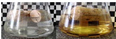
Figura 2.84. Rolhas com revestimento de TTA PBO e NaOH em etanol 40 % (v/v), 0 horas e 1 semana, respetivamente
