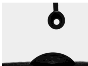
Figura 2.25. Gota de água sobre a superfície de cortiça revestida com TTA WP WCL pH 2,17. AC= 61,37 \pm 12,31
