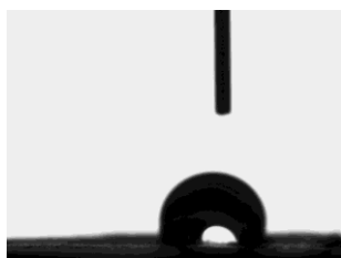
Figura 2.217. Gota de água sobre a superfície de cortiça revestida com JR 125 0,5 %. AC=74,27 ± 21,11 (n=11)
