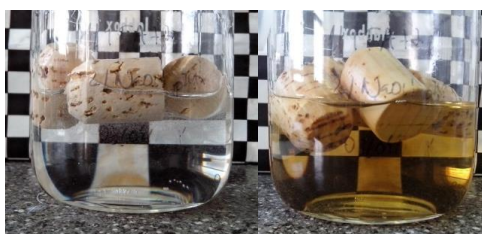
Figura 2.78. Rolhas com revestimento de TTA ++ e NaOH em etanol 40 % (v/v), 0 horas e 1 semana, respetivamente
