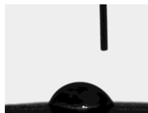
Figura 2.218. Gota de água sobre a superfície de cortiça revestida com JR 125 1 %. AC=66,81 ± 4,29 (n=5)
