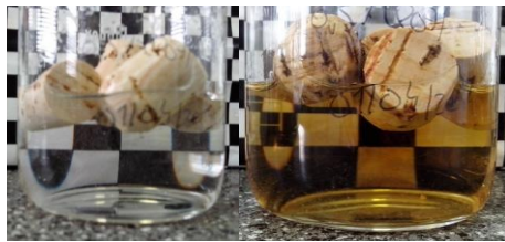
Figura 2.182. Rolhas com revestimento de HPMC Mn 10.000 0,5 % em etanol 40 % (v/v), 0 horas e 1 semana, respetivamente
