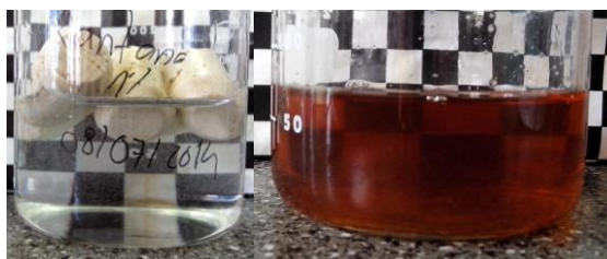
Figura 2.384. Rolhas com revestimento de xantana 1 % em etanol 50 % (v/v), 0 horas e 10 dias a 60°C, respectivamente
