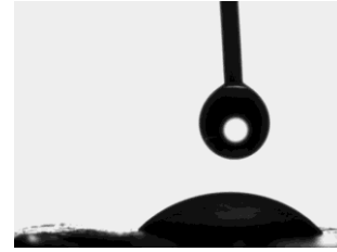
Figura 2.30. Gota de água sobre a superfície de cortiça revestida com TTA PBO pH 5. AC=49,50 ± 4,30
