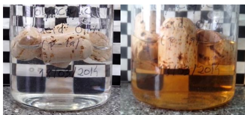
Figura 2.136. Rolhas com revestimento de PAA, Mw 1.080.000, 0,1 % em etanol 40 % (v/v), 0 horas e 1 semana, respetivamente
