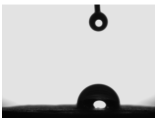
Figura 2.318. Gota de água sobre a superfície de cortiça revestida com SoftCAT SL-100 0,5%. AC = 101,85 \pm 10,80 (n=9)
