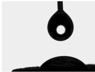
Figura 2.71. Gota de água sobre a superfície de cortiça revestida com TTA PO e NaOH. AC=46,26 ± 26,03
