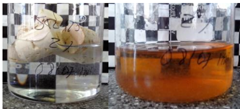
Figura 2.230. Rolhas com revestimento de JR125 2 % em etanol 50 % (v/v), 0 horas e 10 dias a 60 °C, respetivamente
