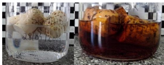
Figura 2.277. Rolhas com revestimento de SoftCAT SK-MH 0,1 % em etanol 40 % (v/v), 0 horas e 10 dias a 60 °C, respetivamente
