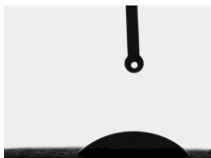
Figura 2.124. Gota de água sobre a superfície de cortiça revestida com PAA 0,1 % Mw 1.080.000. AC= 59,77 \pm 9,22
