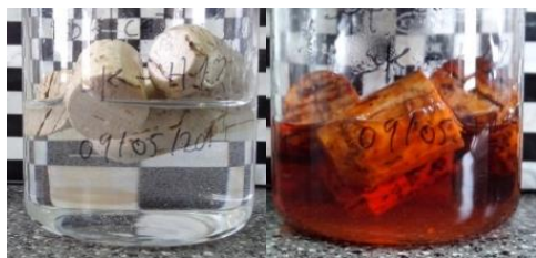
Figura 2.289. Rolhas com revestimento de SoftCAT SK-H 1 % em etanol 40 % (v/v), 0 horas e 10 dias a 60 °C, respetivamente
