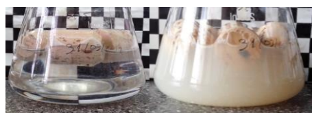
Figura 2.56. Rolhas com revestimento de TTA PBO pH5 em etanol 40 % (v/v), 0 horas e 1 semana, respetivamente
