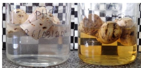
Figura 2.48. Rolhas com revestimento de TTA pH5 em etanol 40 % (v/v), 0 horas e 1 semana, respetivamente
