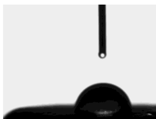
Figura 2.256. Gota de água sobre a superfície de cortiça revestida com SoftCAT SK-L 0,5%. AC = 91,35 \pm 9,70 (n=7)
