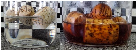
Figura 2.224. Rolhas com revestimento de JR125 0,1 % em etanol 50 % (v/v), 0 horas e 10 dias a 60 °C, respetivamente
