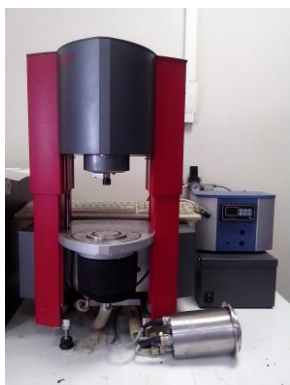
Figura 4.5. Reômetro Stress Tech, da Reologica
