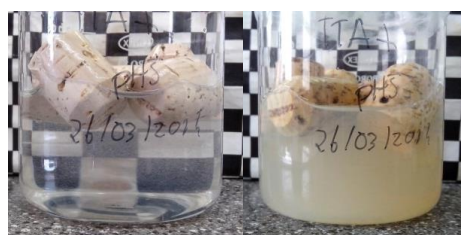
Figura 2.50. Rolhas com revestimento de TTA+ pH5 em etanol 40 % (v/v), 0 horas e 1 semana, respetivamente
