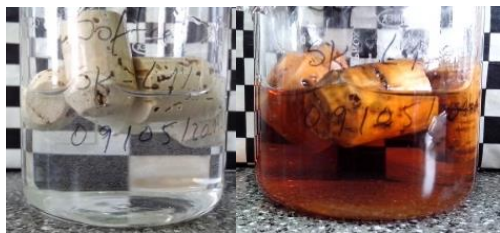
Figura 2.271. Rolhas com revestimento de SoftCAT SK-L 1 % em etanol 40 % (v/v), 0 horas e 10 dias a 60 °C, respetivamente
