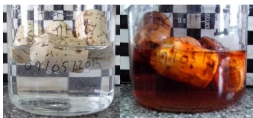
Figura 2.283. Rolhas com revestimento de SoftCAT SK-MH 1 % em etanol 40 % (v/v), 0 horas e 10 dias a 60 °C, respetivamente
