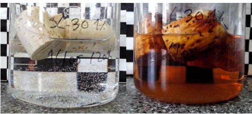
Figura 2.330. Rolhas com revestimento de SoftCAT SL-30 1 % em etanol 40 % (v/v), 0 horas e 10 dias a 60 °C, respetivamente
