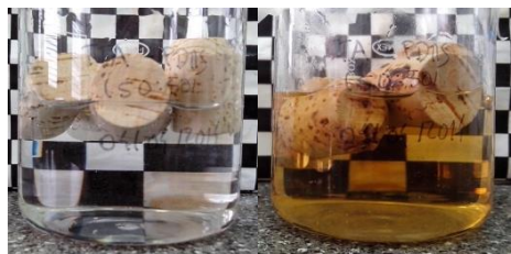
Figura 2.100. Rolhas com revestimento de TTA-PDMS em etanol 40 % (v/v), 0 horas e 1 semana, respectivamente
