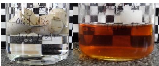
Figura 2.371. Rolhas com revestimento de alginato de sódio 1 % em etanol 50 % (v/v), 0 horas e 10 dias a 60°C, respetivamente
