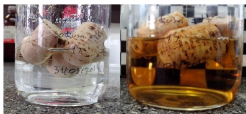
Figura 2.154. Rolhas com revestimento de PAA, sal sódio 1 % em etanol 40 % (v/v), 0 horas e 1 semana, respetivamente
