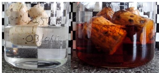
Figura 2.188. Rolhas com revestimento de HPMC Mw 120.000 0,5 % em etanol 50 % (v/v), 0 horas e 10 dias a 60°C, respetivamente
