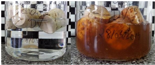
Figura 2.389. Rolhas com revestimento de Polidisp em etanol 50 % (v/v), 0 horas e 10 dias a 60°C, respectivamente
