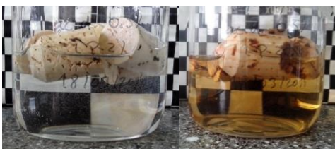
Figura 2.144. Rolhas com revestimento de PAA, Mv 4.000.000 0,5 % em etanol 40 % (v/v), 0 horas e 1 semana, respetivamente
