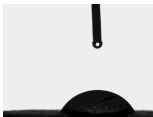
Figura 2.130. Gota de água sobre a superfície de cortiça revestida com PAA Mw 4.000.000 0,1 % pH5. AC=66,76 ± 10,29
