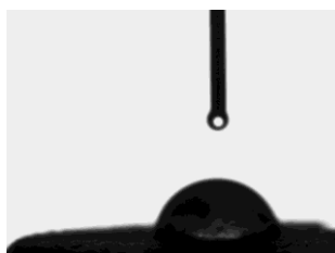
Figura 2.216. Gota de água sobre a superfície de cortiça revestida com JR 125 0,1 %. AC=69,07 ± 15,08 (n=7)
