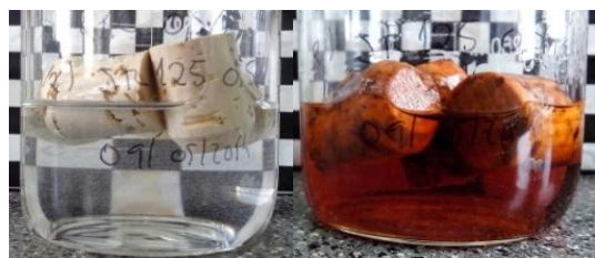
Figura 2.357. Rolhas com revestimento de CMC 0,5% e JR125 0,5% em etanol 50 % (v/v), 0 horas e 10 dias a 60°C, respetivamente
