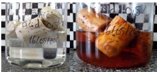
Figura 2.369. Rolhas com revestimento de alginato de sódio 0,5 % em etanol 50 % (v/v), 0 horas e 10 dias a 60°C, respetivamente
