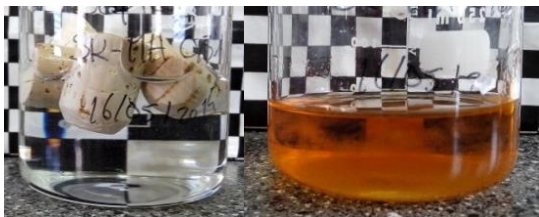
Figura 2.281. Rolhas com revestimento de SoftCAT SK-MH 0,5 % em etanol 40 % (v/v), 0 horas e 10 dias a 60 °C, respetivamente
