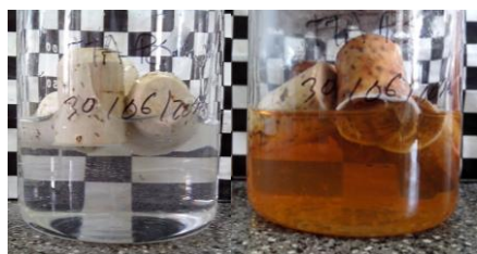
Figura 2.44. Rolhas com revestimento de TTA PO em etanol 40 % (v/v), 0 horas e 10 dias a 60 °C, respetivamente
