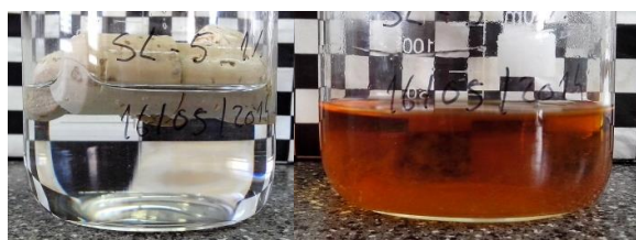
Figura 2.324. Rolhas com revestimento de SoftCAT SL-5 1 % em etanol 40 % (v/v), 0 horas e 10 dias a 60 °C, respectivamente
