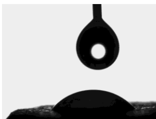
Figura 2.97. Gota de água sobre a superfície de cortiça revestida com TTA WP WCL-PDMS. AC=66,79 \pm 18,18
