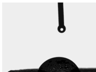
Figura 2.198. Gotas de água sobre a superfície de cortiça revestida com CMC 0,1 %. AC= 74,02 \pm 7,27
