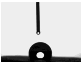
Figura 2.314. Gota de água sobre a superfície de cortiça revestida com SoftCAT SL-60 0,1%. AC = 105,60 \pm 15,02 (n=10)
