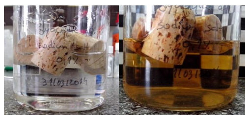
Figura 2.152. Rolhas com revestimento de PAA, sal sódio 0,1 % em etanol 40 % (v/v), 0 horas e 1 semana, respetivamente
