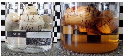
Figura 2.228. Rolhas com revestimento de JR125 1 % em etanol 50 % (v/v), 0 horas e 10 dias a 60 °C, respetivamente
