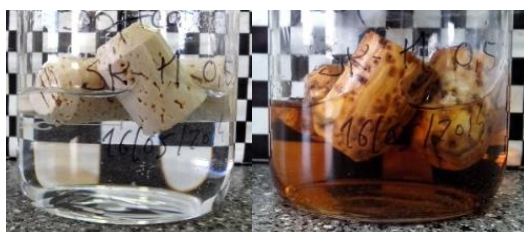
Figura 2.275. Rolhas com revestimento de SoftCAT SK-M 0,5 % em etanol 40 % (v/v), 0 horas e 10 dias a 60 °C, respetivamente
