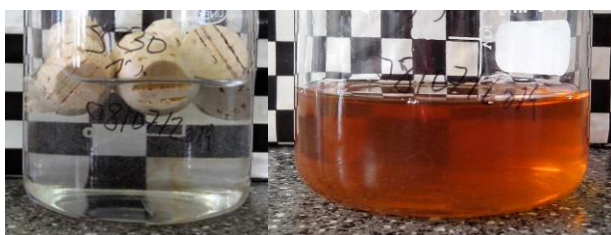
Figura 2.236. Rolhas com revestimento de JR30M 1 % em etanol 50 % (v/v), 0 horas e 10 dias a 60 °C, respectivamente
