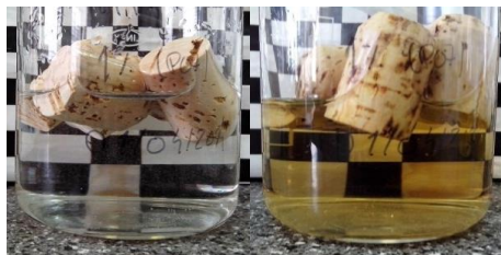
Figura 2.184. Rolhas com revestimento de HPMC Mn 10.000 1 % em etanol 40 % (v/v), 0 horas e 1 semana, respetivamente
