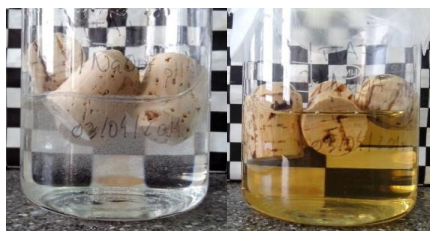
Figura 2.76. Rolhas com revestimento de TTA+ e NaOH em etanol 40 % (v/v), 0 horas e 1 semana, respectivamente
