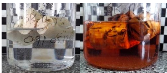
Figura 2.279. Rolhas com revestimento de SoftCAT SK-M 1 % em etanol 40 % (v/v), 0 horas e 10 dias a 60 °C, respetivamente
