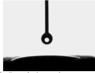
Figura 2.388. Gota de água sobre a superfície de cortiça revestida com Polidisp DV
