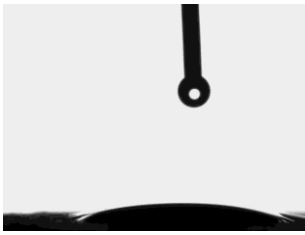
Figura 2.67. Gota de água sobre a superfície de cortiça revestida com TTA e NaOH. AC=27,52 ± 7,16
