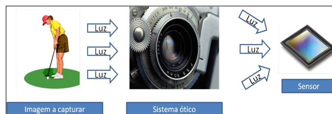
Figura 2.21: Sistema de captura de imagem. O sistema ótico é responsável por concentrar os raios luminosos sobre a matriz de sensores e o sensor converte o sinal luminoso num sinal elétrico.
