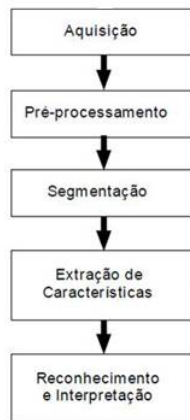
Figura 2.20: Sistema de processamento de imagem comum englobando cinco componentes: aquisição de imagem, pré-processamento, segmentação de imagem, extração e medição de características e a interpretação e classificação.
