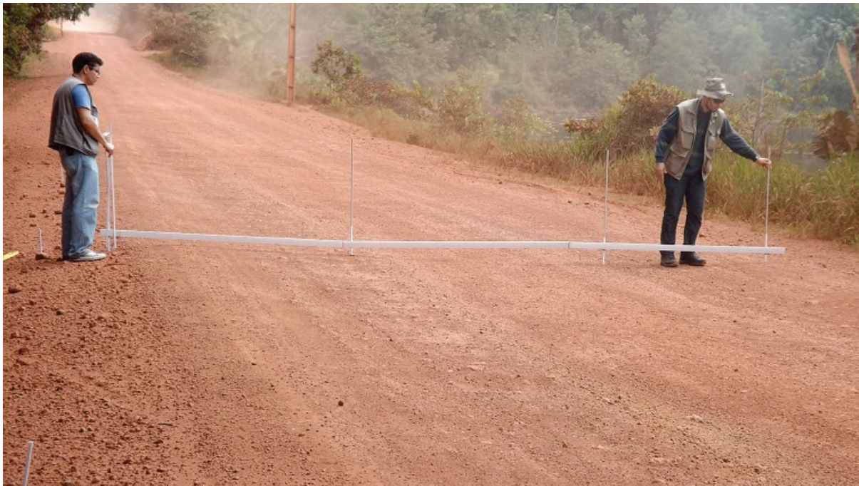
Fotografia 4: M.I.T disposto para a mensuração dos defeitos na rodovia Fonte: Pesquisa de campo
