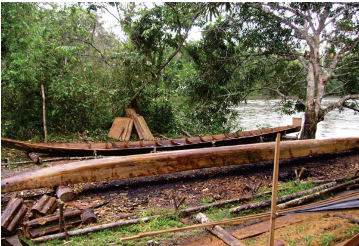
Fotografia 16: Batelões sendo construídos em estaleiro improvisado às margens do rio Iratapuru na comunidade de São Francisco.
