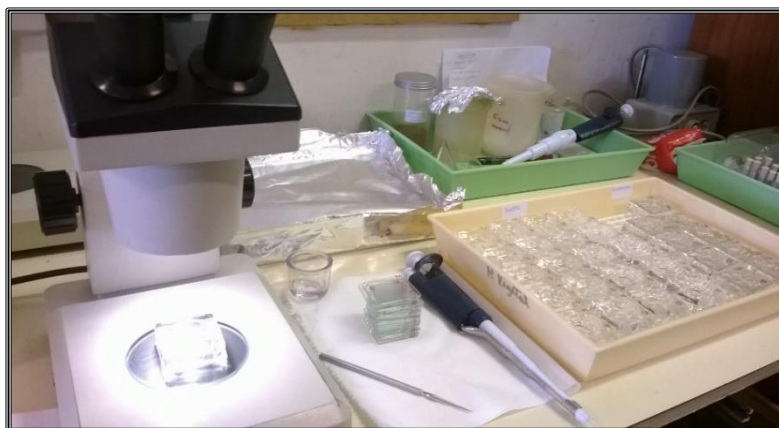
Figura 2. Blocos de vidro escavados no tabuleiro de ensaio com os quistos de G. pallida e 2 mL do extrato/exsudato/água, ao lado do microscópio binocular esterioscópico utilizado para fazer as contagens.
