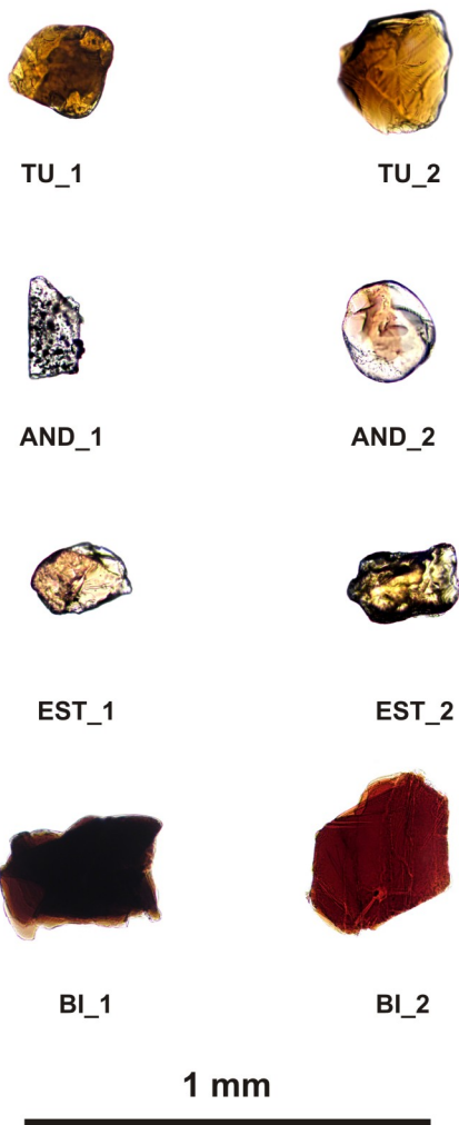
Figura 7. Aspecto visual de alguns grãos de turmalina, andaluzite, estaurolite e biotite identificados nas amostras oriundas da área envolvente ao cabo de Sines. TU_1 – turmalina sub-rolada, TU_2 – turmalina subangulosa, AND_1 – andaluzite angulosa, AND_2 – andaluzite sub-rolada, EST_1 – estaurolite sub-angulosa, EST_2 – estaurolite sub-rolada, BI_1 – biotite sub-rolada, BI_2 – biotite subangulosa (quase euédrica).
