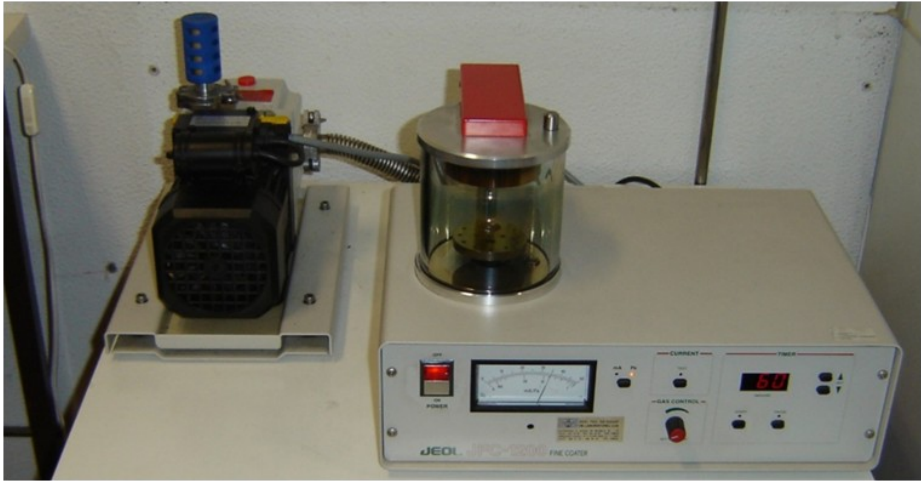
Figura 2. Exemplo de uma câmara para mineralização com ouro (laboratório da FCUL). Figure 2. Example of a chamber where the samples are mineralized with gold (FCUL laboratory).
