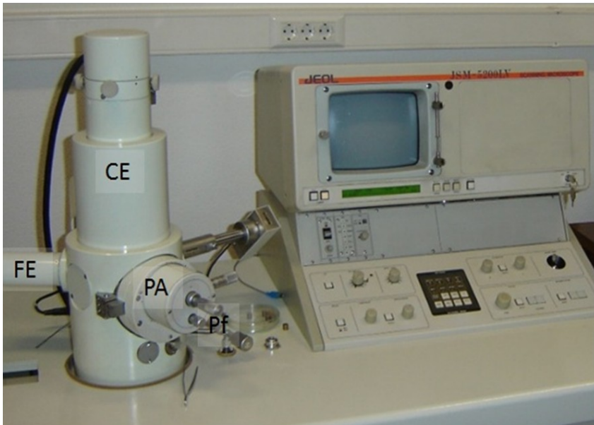
Figura 1. Imagem do microscópio electrónico de varrimento (JEOL – JSM 52000LV) utilizado na Faculdade de Ciências da Universidade de Lisboa (FCUL). É visível (à esquerda) o porta-amostras (PA) cuja movimentação é feita através de três parafusos - Pf), a coluna electro-magnética (CE) e a fonte electrónica (FE). Ao centro, é visível um pequeno monitor e o painel de controlo, onde se ajusta, por exemplo, a resolução e a energia do feixe.
