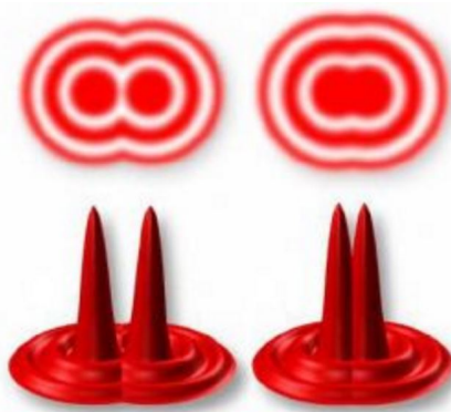
FIGURE 2.15: Dois pontos mostram os limites de detecção. A imagem da esquerda está associada a uma melhor resolução do sistema, ou seja, ao uso de um feixe de comprimento de onda mais reduzido
