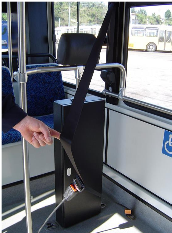
Figura 7: Fixação das cadeiras e comandos nos “Pantufinhas”
