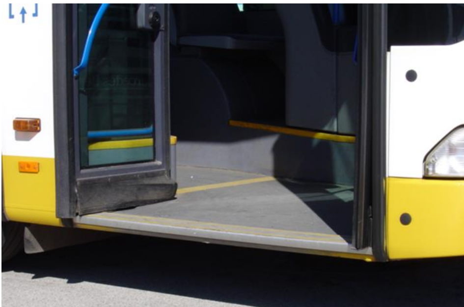
Fotografia 10: Viatura sem degraus de piso rebaixado (Low-Floor)
