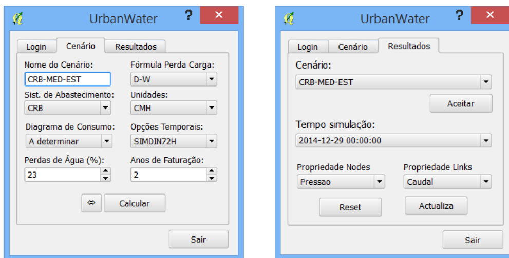
Figura 37 – Interface gráfica do plugin QGIS com o objetivo de possibilitar a definição e execução de uma simulação hidráulica, assim como filtrar os resultados e ajustar a legenda de acordo com os parâmetros selecionados.
