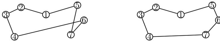
Figura 1.1: Exemplo de uma iteração do algoritmo 2-opt
