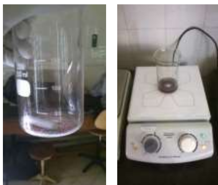
Figura 12 – Algumas etapas do processo de extração sequencial: à esquerda, preparação do material antes da primeira extração com solventes; à direita, atuação do solvente na biomassa algal moída, numa placa de agitação, durante 20 min. (Autor)
