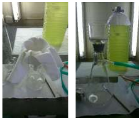
Figura 11 – Metodologia utilizada no processo de filtração da solução de polissacarídeos. À esquerda, a primeira filtração, utilizando um filtro de porcelana e pano-cru, por vácuo em coluna de água. À direita, a segunda filtração, num filtro de sílica (G2), também por filtração em coluna de água. (Autor)
