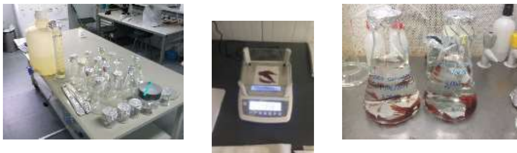
Figura 8 – Preparação dos ensaios laboratoriais. À esquerda, material autoclavado disposto em cima da mesa, para iniciar o ensaio. No centro, quantificação de biomassa para incluir nos matrizes de cultivo, à direita, numa câmara de fluxo, observam-se os matrizes já prontos a colocar em cultura. (Autor)
