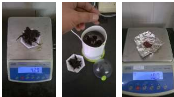
Figura 10 – À esquerda, processo de quantificação de biomassa algal seca em amostras de diferentes origens; no centro, processo de moagem das algas num moinho de café. À direita, quantificação de um 1g de alga seca moída para iniciar o processo de extração. (Autor)
