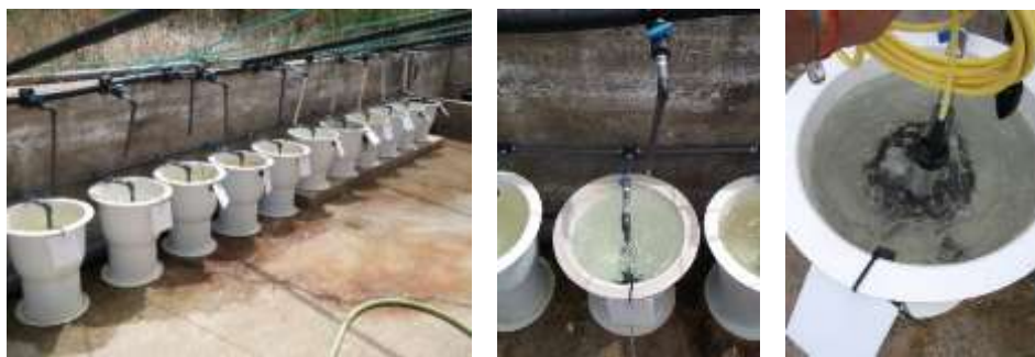
Figura 9 – À esquerda, montagem do sistema de tanques de 15L utilizados na atividade experimental exterior. No centro, close-up num dos tanques permite observar as condições físicas e mecânicas oferecidas aos espécimes de D. carnosa utilizados no ensaio. À direita observa-se a leitura de valores de pH, temperatura (°C) e salinidade (‰), pela sonda do medidor multiparamétrico, a 5 cm de profundidade. (Autor)
