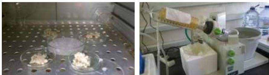
Figura 13 – Na imagem da esquerda, os polissacarídeos de D. carnosus postos a secar na estufa, com Gel de Sílica para absorver eficazmente a humidade. Na imagem da direita observa-se a evaporação total do extratos de n-hexano, num evaporador rotativo, de modo a serem ressuspensos em DMSO. (Autor)
