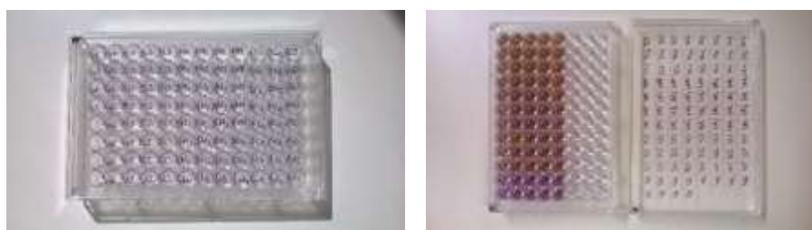
Figura 14 – Esquematização do ensaio de avaliação da capacidade de redução do DPPH numa placa de micropoços. À esquerda, a caracterização da placa garante o correto procedimento do ensaio. À direita, observável a diferença colorimétrica do radical DPPH após incubação com extratos de D. carnososa . (Autor)
