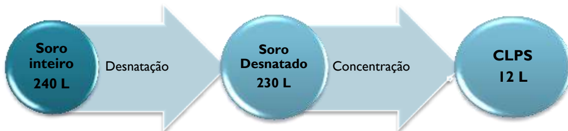
Figura 11 - Esquema da produção dos concentrados de proteína de soro (CLPS).
