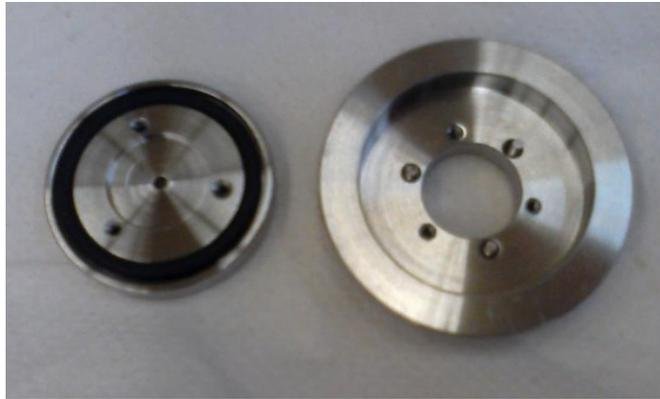
Figura 20: Peça que contém a janela do detetor (à esquerda) e a peça onde essa peça irá aparafusar (à direita).
