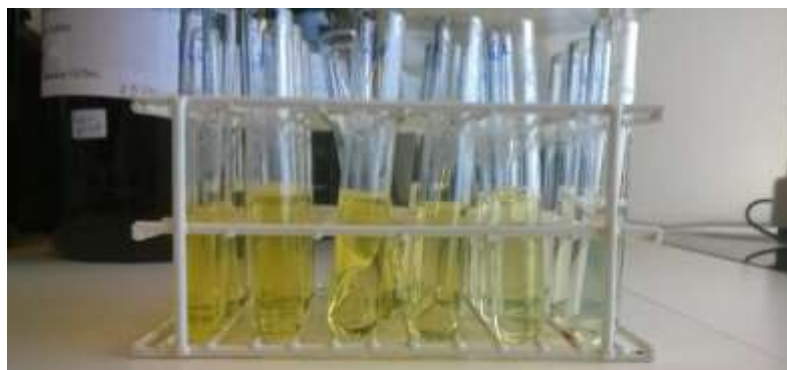
Figura 9. Realização do ensaio da inibição do branqueamento do \beta -caroteno.
