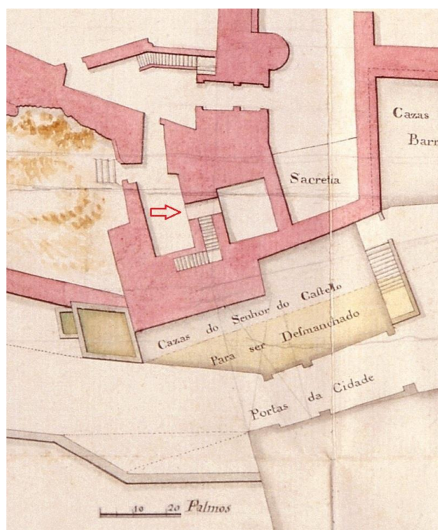
8./Ilustração 23: Extracto da planta DA 126, de Guilherme Elsdén, de 1777 (muito parecida com a existente na BNRJ, de 1772). MNMC, Desenhos de Arquitectura, DA 126. No muro para dentro da sala seria aberto um vão numa largura de 1.32m, coberto de arquivadas de pedra ou abobadado.
