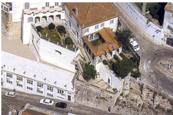
5./Ilustração 3: Extracto de fotografia aérea de 2003, onde se veem os muros, com algum afastamento entre si, que supõem terem permitido o corte da antiga rampa de acesso ao arco triunfal. No canto inferior esquerdo a couraça manuelina, abaluartada, cumpriu o seu papel de reforço e travamento dos antigos muros (Jorge & Bandeirinha, 2003, p. 31).
