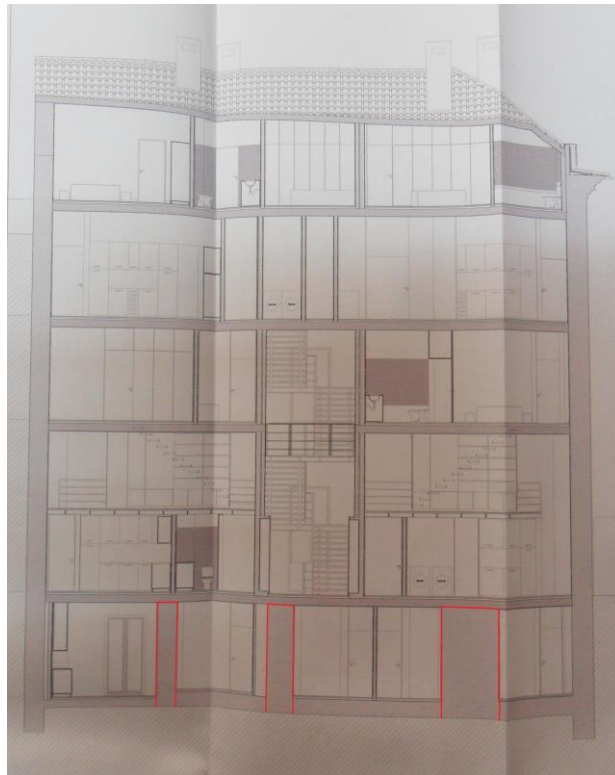
5./Ilustração 35: Corte longitudinal do edifício na rua de Joaquim António de Aguiar nº 55/59, onde foram encontradas estruturas em pedra na cave. IPPA (DRC), R. Joaquim António de Aguiar nº 55/59, proc. nº (99) 06.03/36, 1999. A vermelho, encontram-se assinaladas algumas dessas estruturas.
