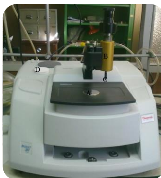
Figura 2.5. Aparelho de FTIR-ATR: A – Cristal de diamante; B – Torre de pressão giratória; C – Ponta de pressão e D – Tampa para líquidos voláteis.
