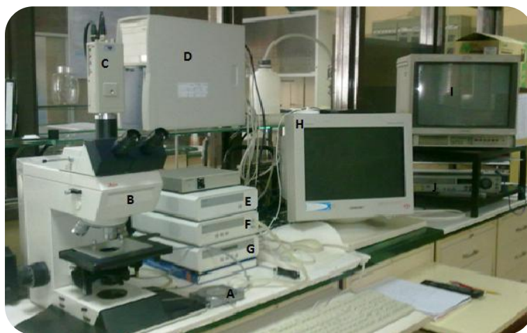
Figura 2.4. Equipamento de termomicroscopia: A) Placa de aquecimento; B) Microscópio de luz polarizada; C) Câmara de vídeo; D) Computador; E) Interface Gráfica; F) Sistema de controlo de refrigeração; G) Interface de computador; H) Monitor; I) Televisão; J) Gravador de vídeo.
