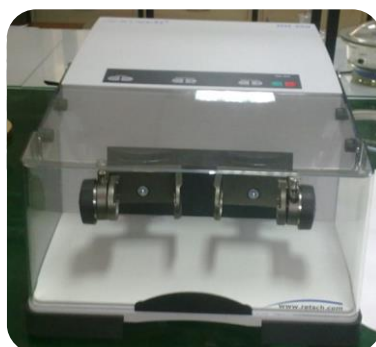
Figura 2.1. Moinho de bolas (Moinho Retsh MM400), usado na obtenção das misturas binárias dos diferentes sistemas estudados.
