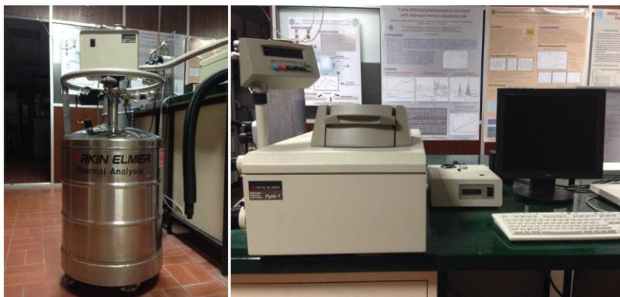
**Figura 2.2.** Fotografia do calorímetro diferencial de varrimento equipado com um reservatório de azoto líquido (DSC Pyris 1).
