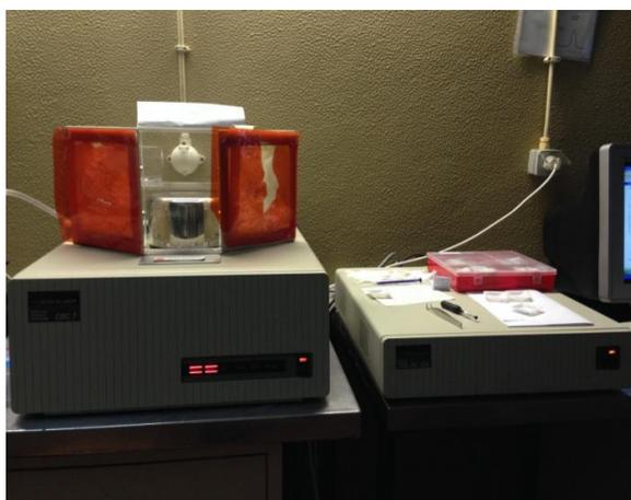
**Figura 2.3.** Fotografia do calorímetro diferencial de varrimento equipado com um banho de refrigeração (DSC 7).
