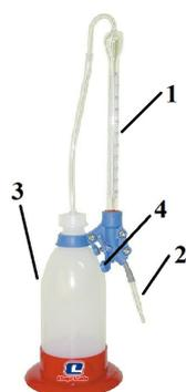
Figura 2.2.12: Acidímetro de Dornic que corresponde a uma bureta graduada com ajuste automático do zero (permite continuar as titulações e evitar o contato do titulante com a atmosfera)- (1)- Bureta Graduada; (2)- Saída de NaOH; (3)- Reservatório de NaOH ( $0.111 \text{ mol/dm}^3$ ); (4)- Sistema de enchimento da a bureta com NaOH.
