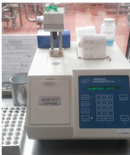
Figura 2.2.14: Crioscópio utilizado no laboratório de controlo da concentração de lactose no leite.
