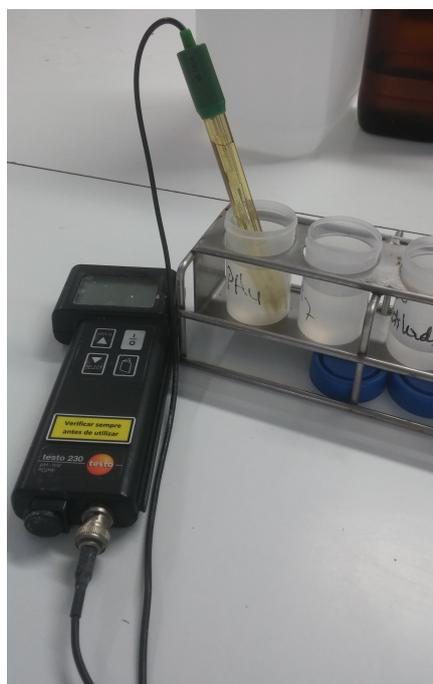
Figura 3.1.4: Eléctrodo Testo
