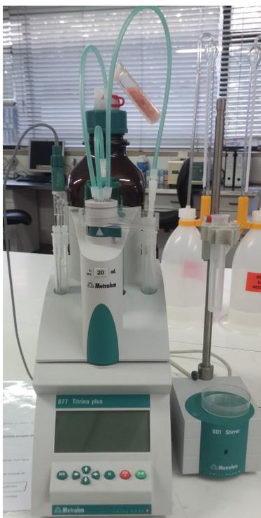
Figura 3.1.3: Sistema automático integrado (Potenciômetro Titrino Plus 877) para determinação do grau de acidez em amostras de leite
