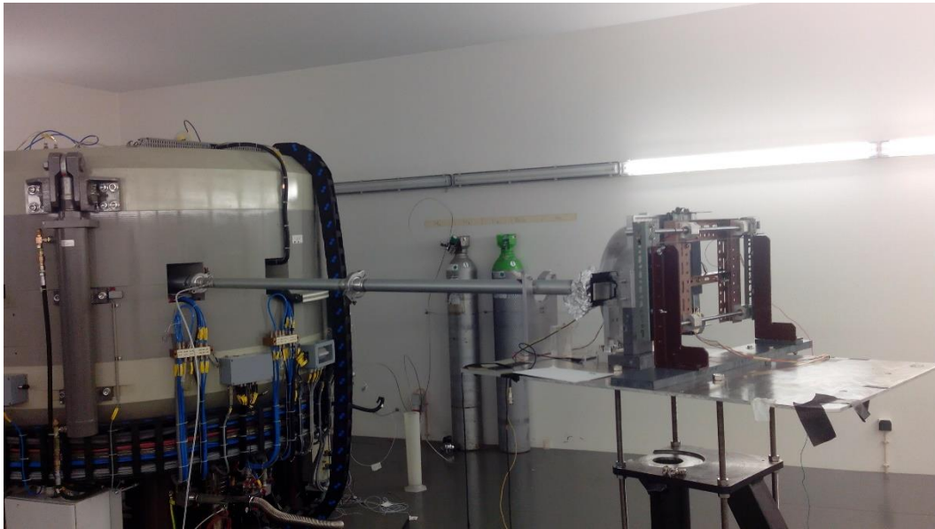
Figura 4.12 – Fotografia do ciclotrão instalado no ICNAS com a montagem mecânica utilizada para degradar o fluxo de prótons.
