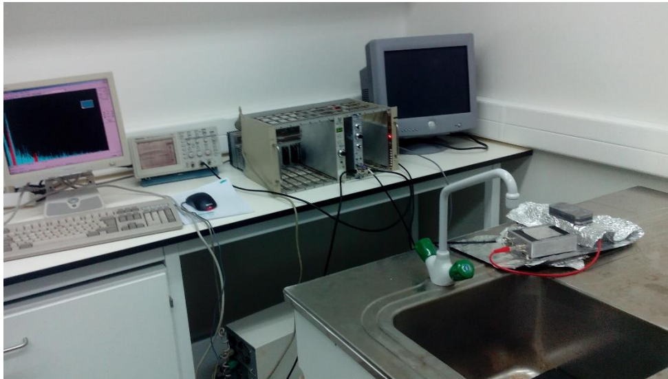
Figura 4.2 – Fotografia do detetor de CdTe e instrumentação para aquisição do sinal constituído por pré-amplificador, amplificador, osciloscópio e analisador multicanal.
