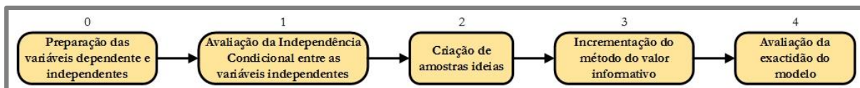
Figura 48 - Sequência de etapas envolvidas na implementação do método do valor informativo, tendo em vista a produção de cartografia de susceptibilidade a movimentos de vertente.
