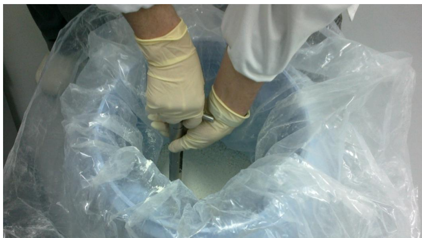
Figura 3.1 - Amostragem da nimesulida (matéria-prima) com o auxílio de uma sonda.
