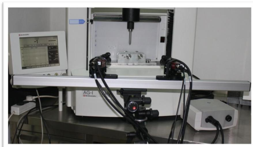
**Figura 55** Fotografia da montagem das câmaras direcionadas para a haste vertical, sob a qual ficará o sistema pilar-implante-osso durante o ensaio.
