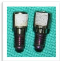
**Figura 49** Pilares de cicatrização para os implantes *Screw-line Promoté® Plus* Ø4,3mmx13mm (Camlog Biotechnologies®, Wimsheim, Germany) usados neste estudo: plataforma PS (à esquerda) e plataforma SD (à direita). Nesta fotografia é ainda possível observar os padrões aplicados na área de interesse para efetuar as medições por CID 3D.
