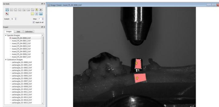
**Figura 58** Imagem de referência para o 1ºensaio na 2ªmandíbula com pilar PS onde podem observar-se os pontos iniciais selecionados (balões a amarelo) e as áreas de interesse (retângulos a rosa) consideradas para o ensaio.
