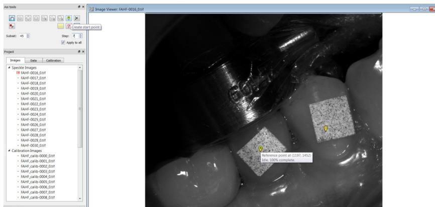
**Figura 21** Imagem do Vic-3D 2010 onde pode observar-se a aplicação de pontos iniciais (pequenos balões amarelos) para a correlação. (Note-se que, para o ponto mais à esquerda, iluminado a verde no centro, foi possível obter 100% de correspondência em todas as imagens selecionadas para o projeto em análise.)
