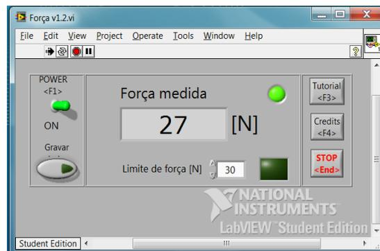
**Figura 67** Imagem da *interface* usada para medição e registo da carga aplicada. No caso exemplificado, pode observar-se que a célula está a medir corretamente (luz a verde acesa), contudo ainda não foi atingido o limite de força estipulado (30N).
