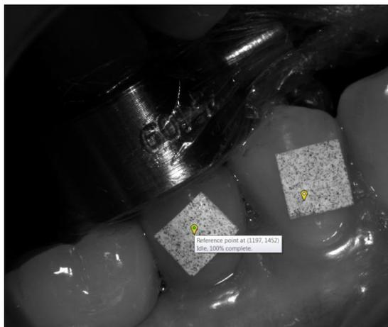
**Figura 69** Imagem de referência para um ensaio onde podem observar-se os pontos iniciais selecionados (balões amarelos) com 100% de correspondência.
