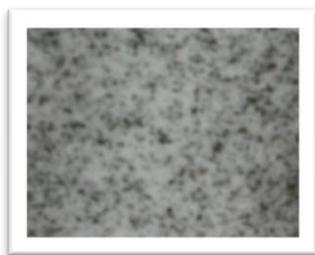
**Figura 50** Fotografia do padrão de manchas utilizado no ensaio experimental.
