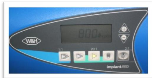
**Figura 41** Fotografia do visor do motor de implantes usado neste estudo para preparação dos leitos implantares. Pode observar-se o programa selecionado (20:1) e a rotação escolhida (800rpm) para o efeito.
