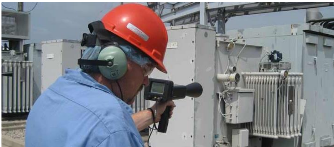
Figura 13-Utilização de um sensor de ultrassons para a análise local (UESystems, 2015).
