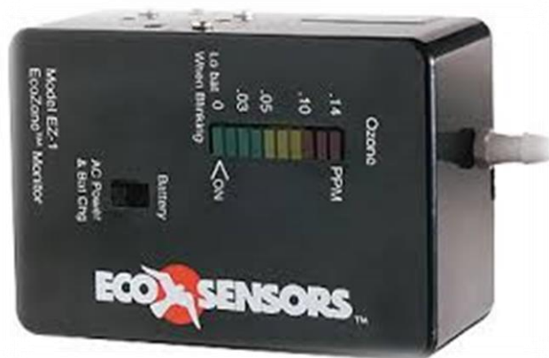
Figura 12-Ilustração de um sensor de concentração de moléculas de ozono (Cole-Parmer, 2015).
