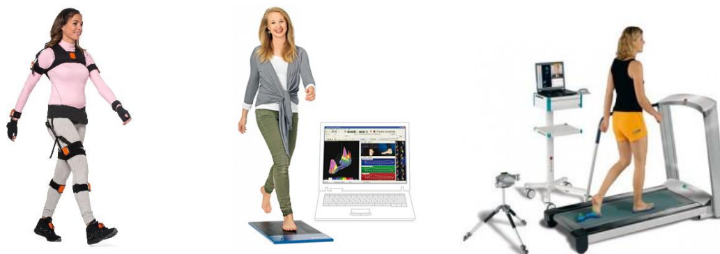
Figura 3.1 - Sistema de aquisição da marcha utilizando sensores de inércia (esquerda), uma plataforma de forma (centro) e uma passadeira (direita) [46] [48] [49].
