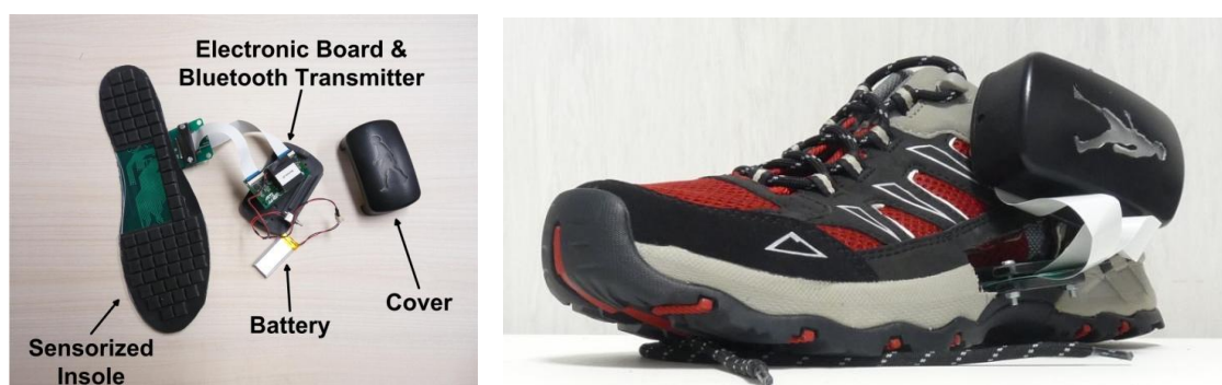
Figura 3.11 - Palmilha de silicone com as unidades sensíveis ligada aos componentes eletrónicos (esquerda) e aspeto final após a incorporação da palmilha no calçado [62].
