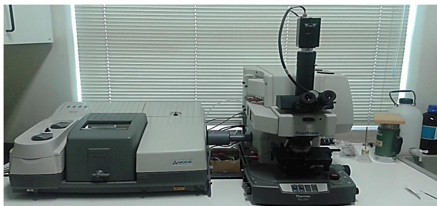
Figura 20 - Espectrómetro ThermoNicolet com detetor MCT acoplado a microscópio Nicolet modelo Continuum.
