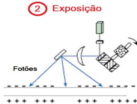
Figura 4 - Diagrama esquemático do processo xerográfico. Adaptado de [8].
