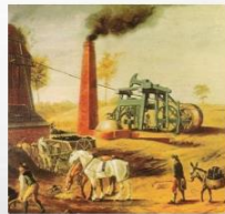
Máquina a vapor usada para bombear as águas das minas (Pintura anónima, do séc. XIX).
