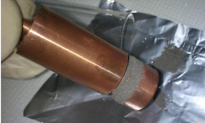
*Figura 5.24: Fotografia da amostra AM2 aglomerada no porta-amostras, apenas com o desmoronamento parcial.*
