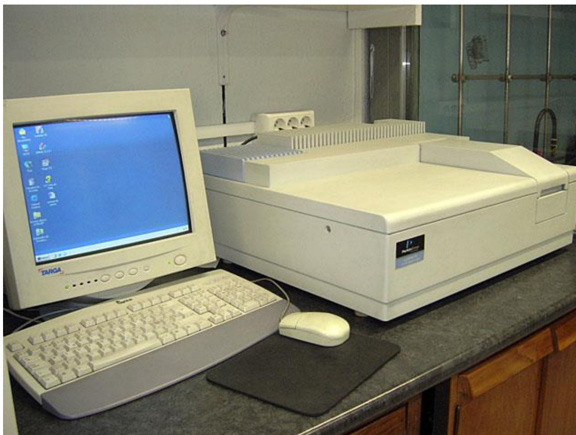
Figura 2.3: Espectrófotometro PerKin Elmer Lambda 35 de duplo feixe e dupla lâmpada.
