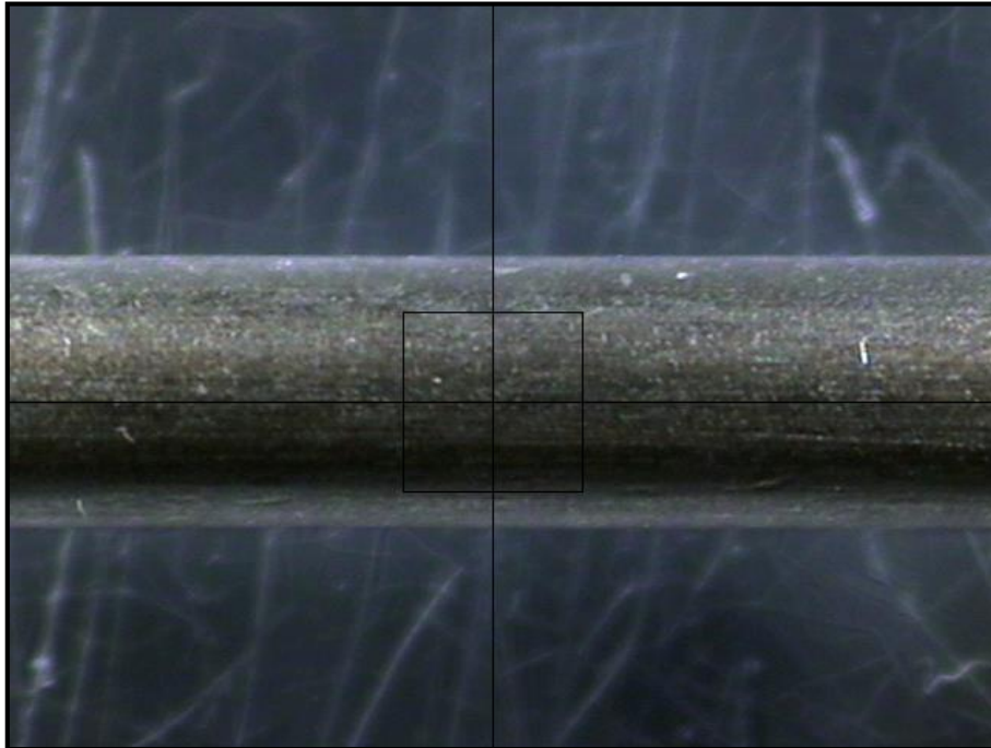
Figura 3.5: Ilustração representativa do ânodo após aplicada uma tensão de 10 V, em solo não contaminado.
