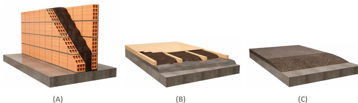
Figura 7.9 – Exemplo de aplicação do granulado de cortiça: (A) Enchimento de paredes duplas interiores; (B) Enchimento de caixas sobre laje esteira; (C) Piso rústico decorativo. Fonte: Amorim Isolamentos S.A.
