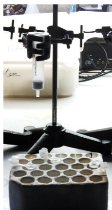
Figura 16 – Filtração da amostra com coluna de extração em fase sólida Chromabond C18.
