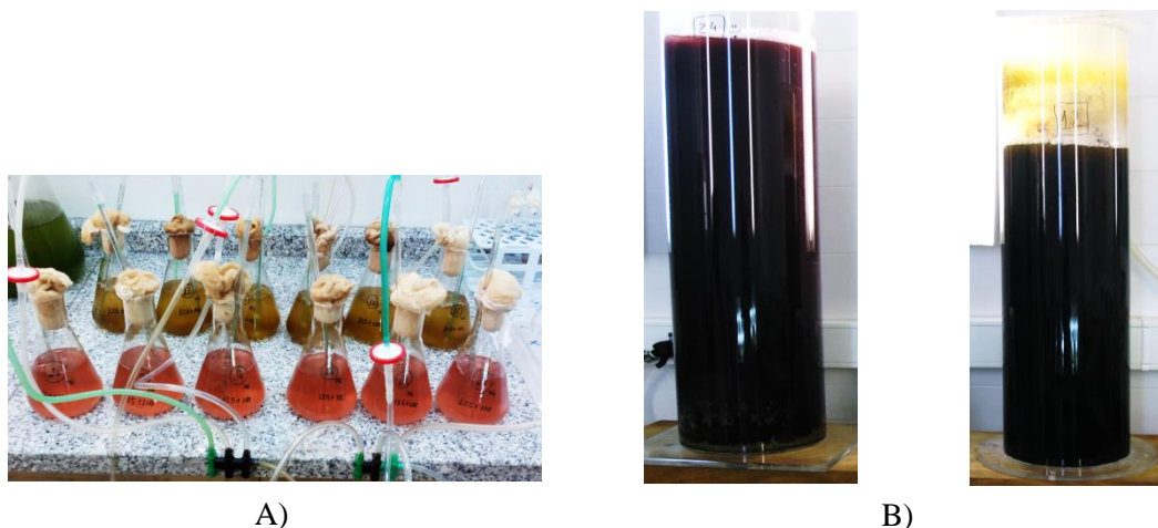
Figura 9 – Cultivo das microalgas em estudo em balões Erlenmeyer de 250mL (A) e reatores em coluna de 20L (B), sendo as culturas de Porphyridium purpureum identificáveis pela coloração vermelha enquanto as de Chrysothila lamellosa se apresentam douradas/acastanhadas.
