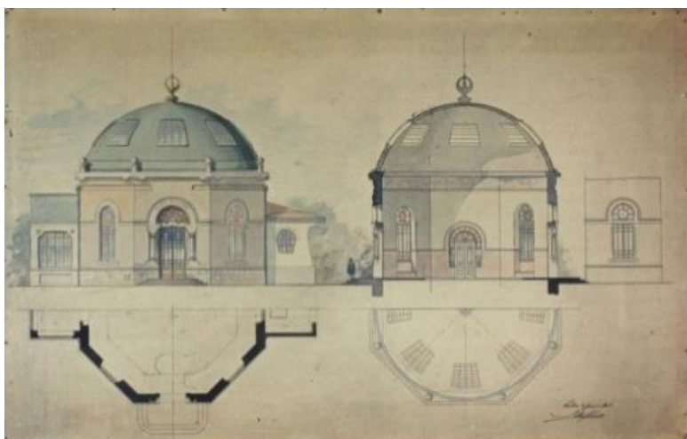
Figura 80. Sabroso, António Rodrigues da Silva Júnior, alçado, corte e plantas do projecto de pavilhão da Fonte do Sabroso, 1907
