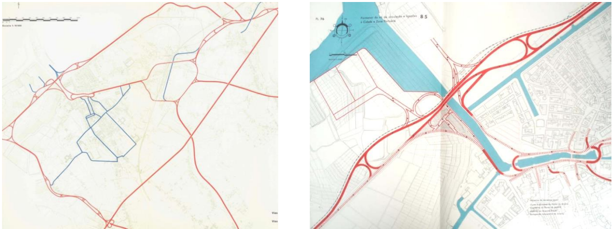
Fig.14 | Plano Director da Cidade de Aveiro (1964), Robert Auzelle – Rede de circulação e pormenor do nó de acesso à cidade e zona portuária
