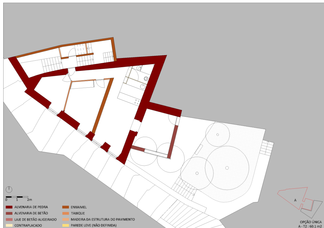
93 e 94 | Análise dos elementos construtivos - plantas do pisos 1 do existente (em cima) e do projeto (em baixo - opção única).
