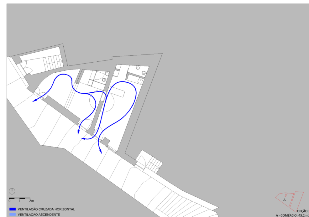
113 e 114 | Ventilação Natural - plantas do projeto do piso 0 (opção 1 em cima e opção 2 em baixo).
