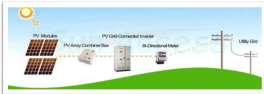
Figura 4 - Esquema simplificado de um sistema fotovoltaico ligado à rede 11
