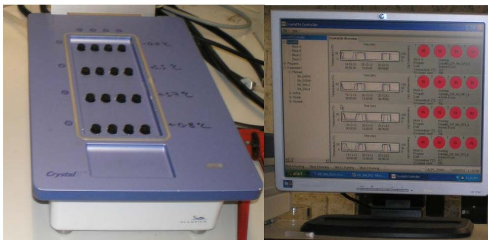
**Figura A1.1** Equipamento para a determinação da solubilidade, Crystal 16 da Avantium Technologies.
