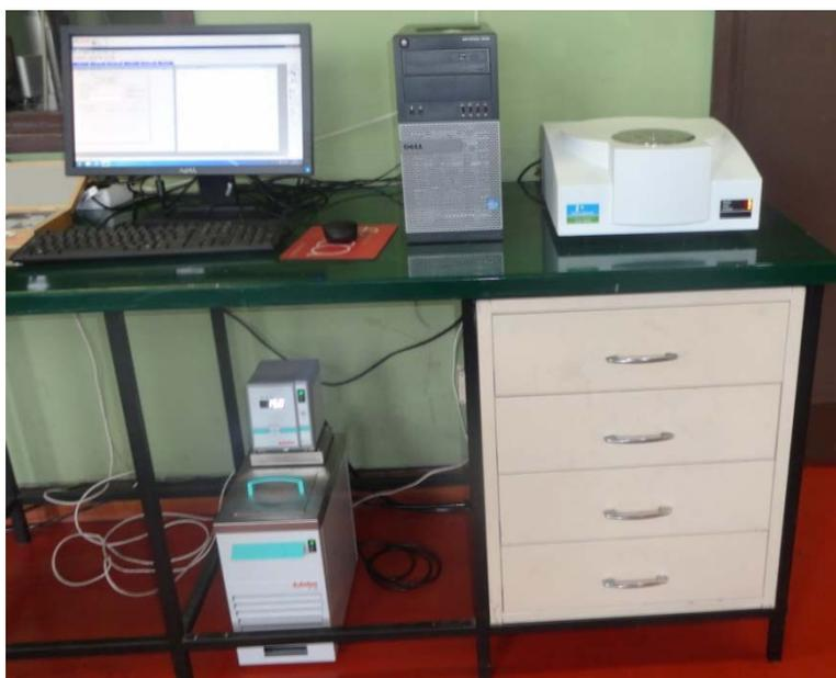
**Figura A1.5** Equipamento utilizado nos estudos de termogravimetria STA 6000, da Perkin Elmer.
