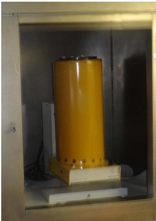
**Figura A1.6** Calorímetro de fluxo de calor, Calvet C80 da Setaram.
