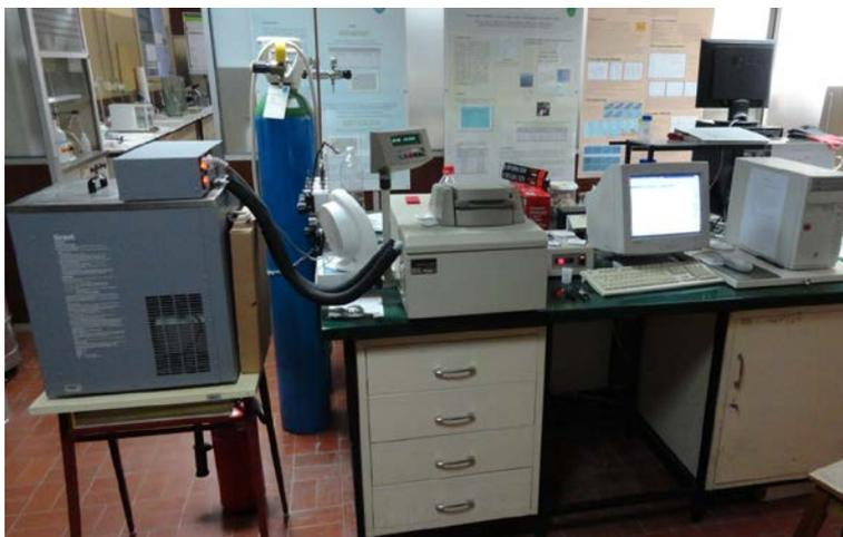
**Figura A1.3.** Calorímetro de compensação de potência Pyris 1, da Perkin Elmer.
