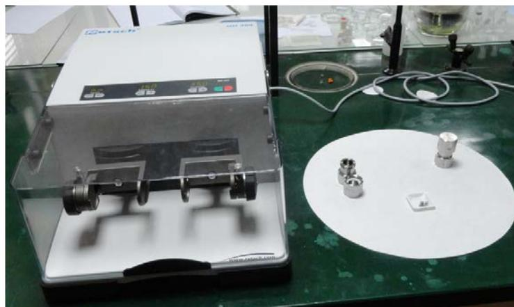
**Figura A1.2.** Moinho de bolas Retsch MM 400.
