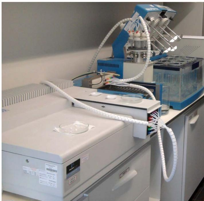
**Figura AI.12.** Equipamento do tipo 2 da SOTAX, utilizado na realização das experiências para determinação da velocidade de dissolução intrínseca.
