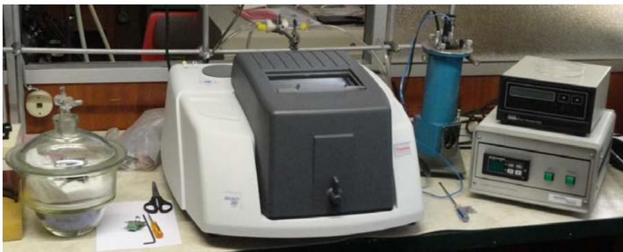
**Figura A1.8** Espectrómetro de infravermelho com transformada de Fourier (FTIR) ThermoNicolet IR300.
