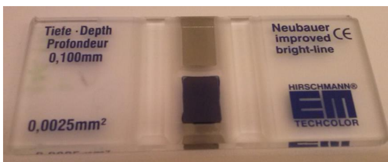
Figura 2.3- Câmara de Neubauer e método de contagem recorrendo ao corante azul tripano.
