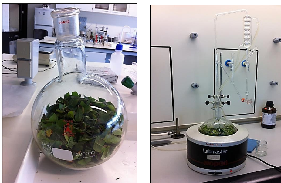
Figura 10. Aparelho do tipo Clevenger modificado.
