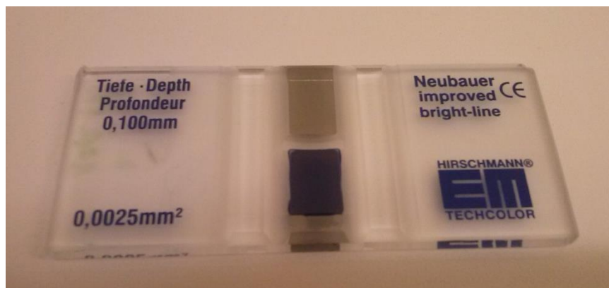
Figura 13. Hemocitómetro e técnica de contagem celular utilizando o método de exclusão do azul tripano.
