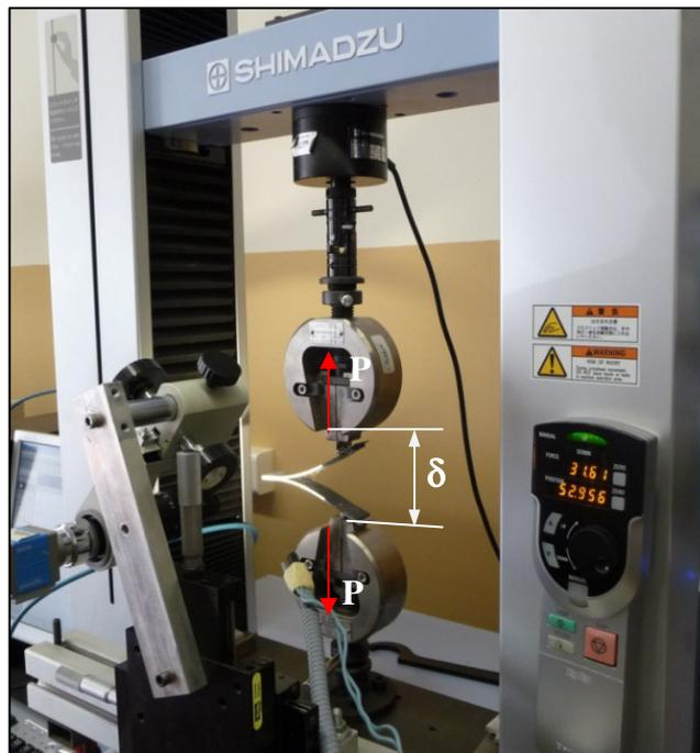
Figura 3.14. Máquina utilizada nos ensaios de Fratura Interlaminar.
