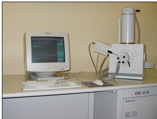
Figura 3.25. Microscópio eletrônico de varrimento, Siemens XL 30.
