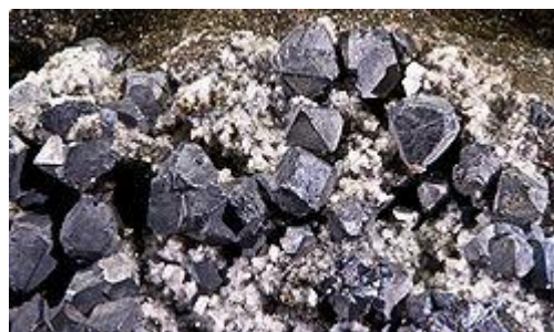
Figura 7- Galena, mineral de chumbo mais comum é o sulfeto de chumbo (II) denominado galena [adaptado de 26].
