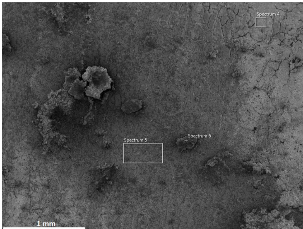
Figura 57 – Micrografia de uma zona da pista de desgaste na amostra de NBR revestida, em que o pino utilizado para provocar o desgaste foi de Al.
