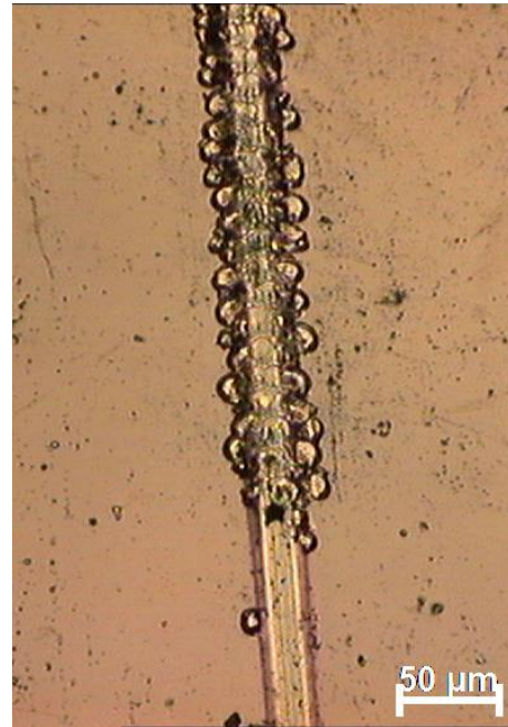
Figura 32 - Micrografia do início da Lc na amostra de aço D2 revestida sob condição 02.
