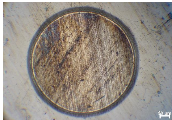
Figura 29 - Micrografia da cratera criada na amostra de aço D2 revestida sob condição 04.
