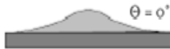
Figura 1.11-c) – A um AC igual a 0° corresponde uma superfície totalmente molhável, adaptada de [27] .
