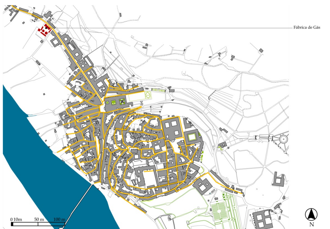
fig. 20 – Planta de reconstituição da rede de gás e com a implantação da fábrica de gás
