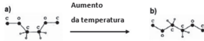
Figura 5 - Alteração da conformação polar (a) dos grupos oxietileno para uma conformação menos polar (b), com o aumento da temperatura. 34
