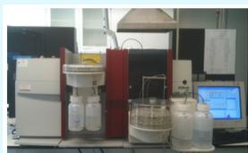
Figura 13: Espectrofotômetro Analytik jena, modelo AAS ZEE nit 700
