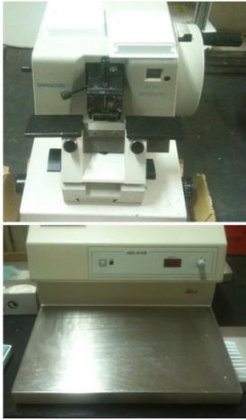
Figura 11: Em cima apresenta-se o micrótomo e em baixo a placa fria utilizados
