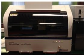
Figura 14: Equipamento de Fluorescência de Raios-X - Hitachi modelo SEA 6000VX
