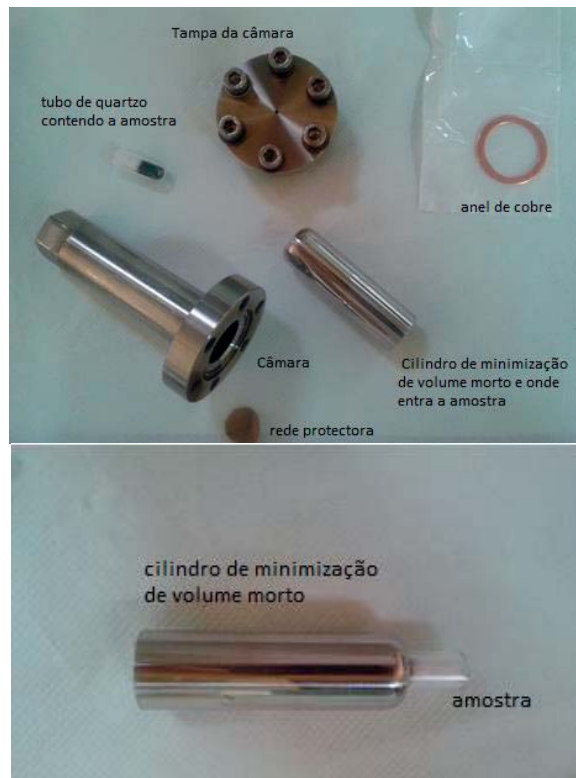
Figura 3-4 - Câmara para introdução da amostra e respectivas peças de montagem (adaptado de [104]).
